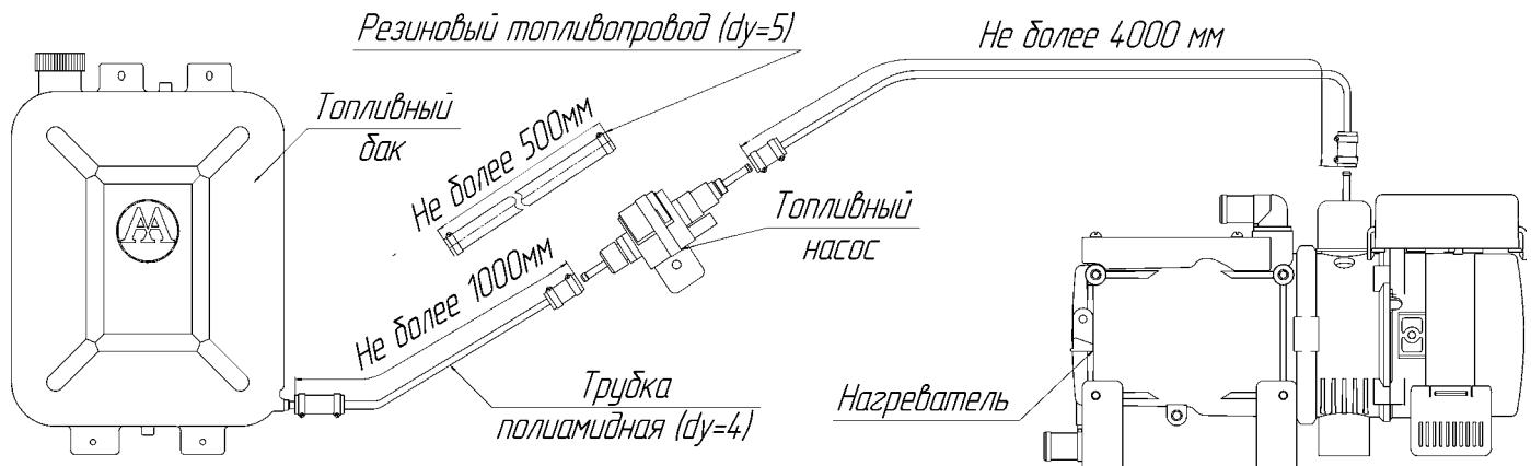
Рис. 9- Схема присоединения топливопровода к узлам подогревателя
