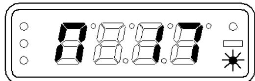
Рис. 6.14 – Индикатор после выключения подогревателя.
