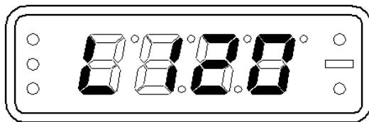
Рис.6.8 - Индикация времени непрерывной работы подогревателя.
