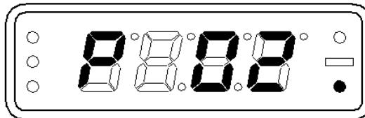
Рис. 6.9 – Индикатор при работе подогревателя в режиме розжига.
